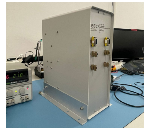
Imatge 10. Superior: Integració i testatge del model d'aviònica (AVM) de la unitat de control del telescopi (TCU) d'Ariel. Inferior: Model d'aviònica (AVM) de la unitat de control del telescopi (TCU) d'Ariel lliurat l'agost de 2025. Crèdits: IEEC.
