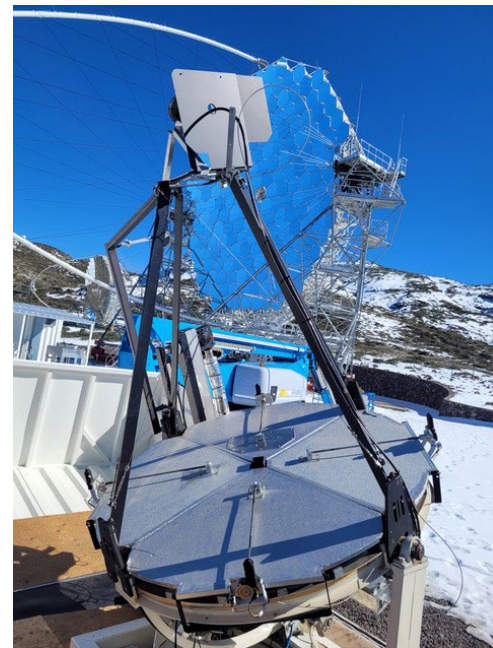
Imatge 12. Detall del LIDAR amb l'LST-1 al fons, pres durant la seva campanya de proves a l'Observatori del Roque de los Muchachos. Crèdits: Paolo Calisse (CTAO).
